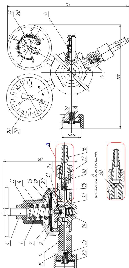
Рис. 1. Регулятор расхода газа баллонный одноступенчатый крупногабаритный:
