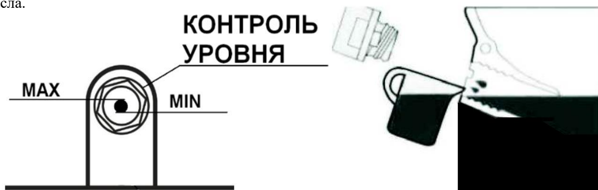
Рисунок 6 – Проверка уровня масла в корпусе редуктора
