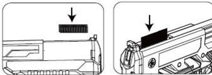
При вкладывании полоски гвоздей держите скобосшиватель с небольшим наклоном так, чтобы гвозди прилегали к боковой стенке.
