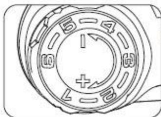
Поверните регулятор против часовой стрелки, чтобы уменьшить силу удара.
