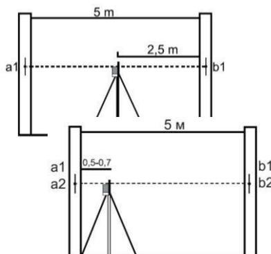
Установить лазерный построитель плоскостей на расстоянии 0,5-0,7 м от стены и нанести, как указано выше, те же отметки. Если разности  $(a1-a2)$  и  $(b1-b2)$  не отличаются друг от друга более чем на величину „точность”, заявленную в технических характеристиках, точность Вашего лазерного построителя в допустимых пределах.
