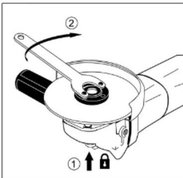
**Внимание!** Запрещается пользоваться кнопкой-фиксатором для остановки вращающегося шпинделя. Это может привести к повреждению устройства!
