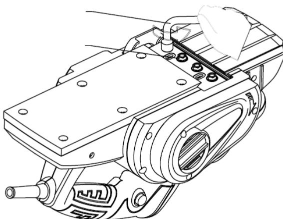
После проведенной операции необходимо подпереть нож к твердой поверхности и легким движением вбок вытащить нож из прижимных пластин и заменить его при необходимости.
