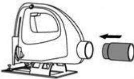
Использование пылеудаления очень практично при последовательной резке, поскольку оно сокращает необходимость прерывания работы для очистки инструмента и рабочей зоны.
