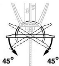
**Помните!** Пиление под углом производится только в прямом направлении. Изменение направления пиления может привести к поломке пильного полотна и, как следствие, к травмам.
