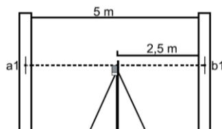
Установить лазерный построитель плоскостей на расстоянии 0,5-0,7 м от стены и нанести, как указано выше, те же отметки. Если разности (a<sub>1</sub>-a<sub>2</sub>) и (b<sub>1</sub>-b<sub>2</sub>) не отличаются друг от друга более чем на величину „точность”, заявленную в технических характеристиках, точность Вашего лазерного построителя в допустимых пределах.
