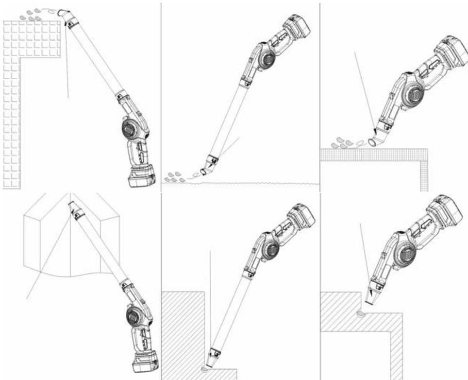
Использование воздуходувки возможно как с удлинительной трубой (5), так и без неё, в зависимости от обрабатываемой поверхности и её доступности.
