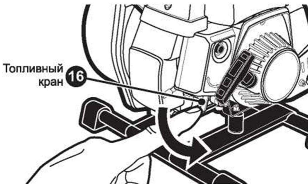
Откройте топливный кран 16, повернув его рычаг вниз.
