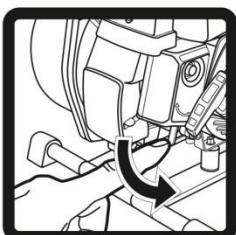
5. Откройте топливный кран, повернув его рычаг вниз.
