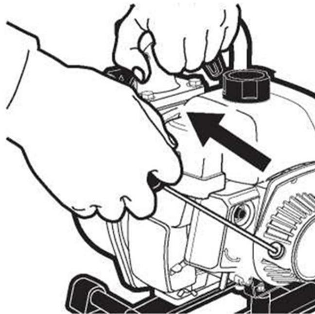
Медленно вытягивайте на себя пусковую рукоятку до того момента, когда вы почувствуете сопротивление. Это точка «компрессии». Затем резко потяните на себя. Не вытягивайте веревку пускового механизма до конца. После запуска двигателя дайте пусковой рукоятке плавно вернуться в исходное положение, придерживая ее при этом рукой.
