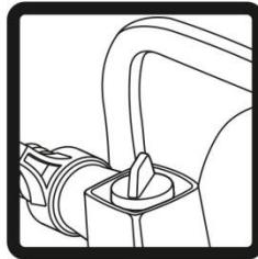
4. Закрутите заливную пробку центробежного насоса.
