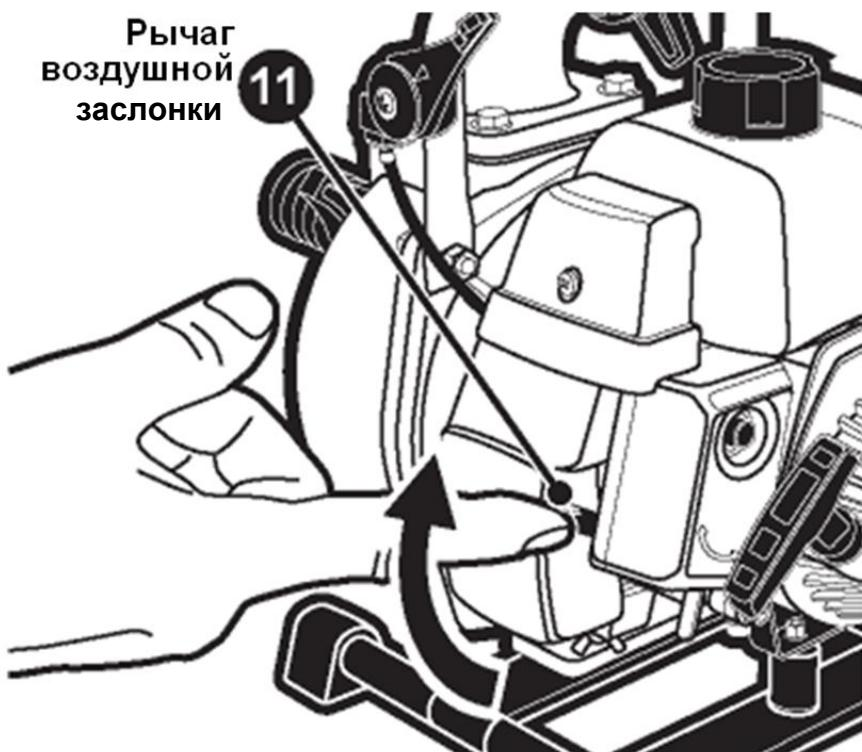
Если двигатель холодный или если он запускается при низкой температуре окружающего воздуха - полностью закройте воздушную заслонку, установив ее рычаг 11 в положение "Пуск холодного двигателя" (CLOSE).
