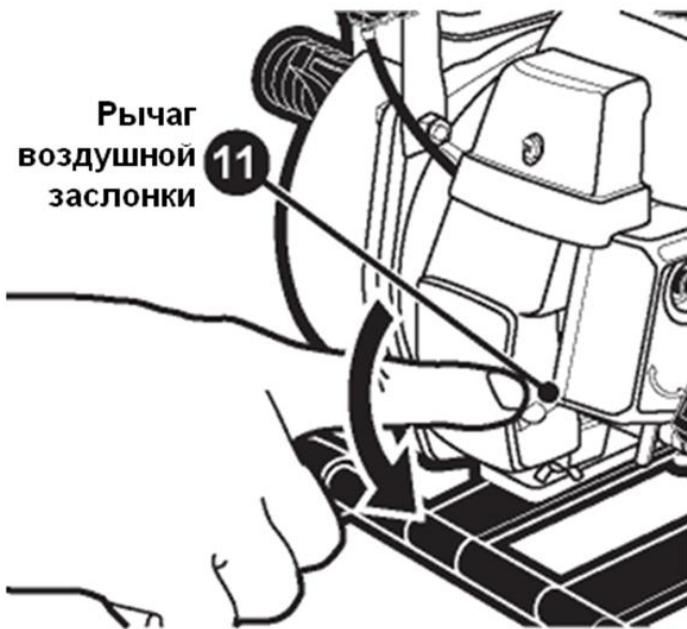
После того, как двигатель запустится, медленно откройте воздушную заслонку и оставьте ее в полностью открытом положении. Не переводите рычаг воздушной заслонки 11 в полностью открытое положение сразу же после запуска двигателя, если двигатель является холодным, или он
