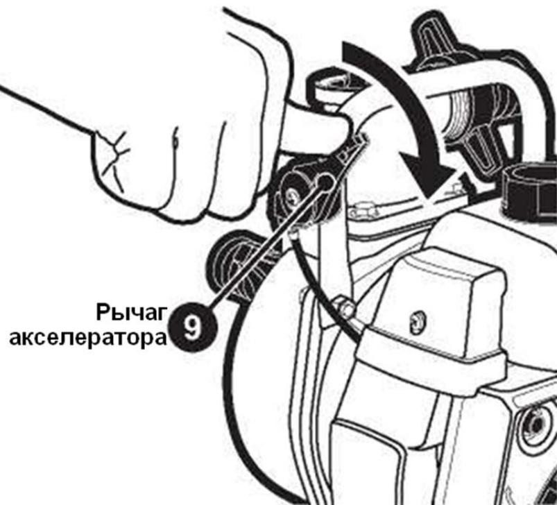
Поверните рычаг акселератора 9 в крайнее правое положение, соответствующее максимальной частоте вращения.
