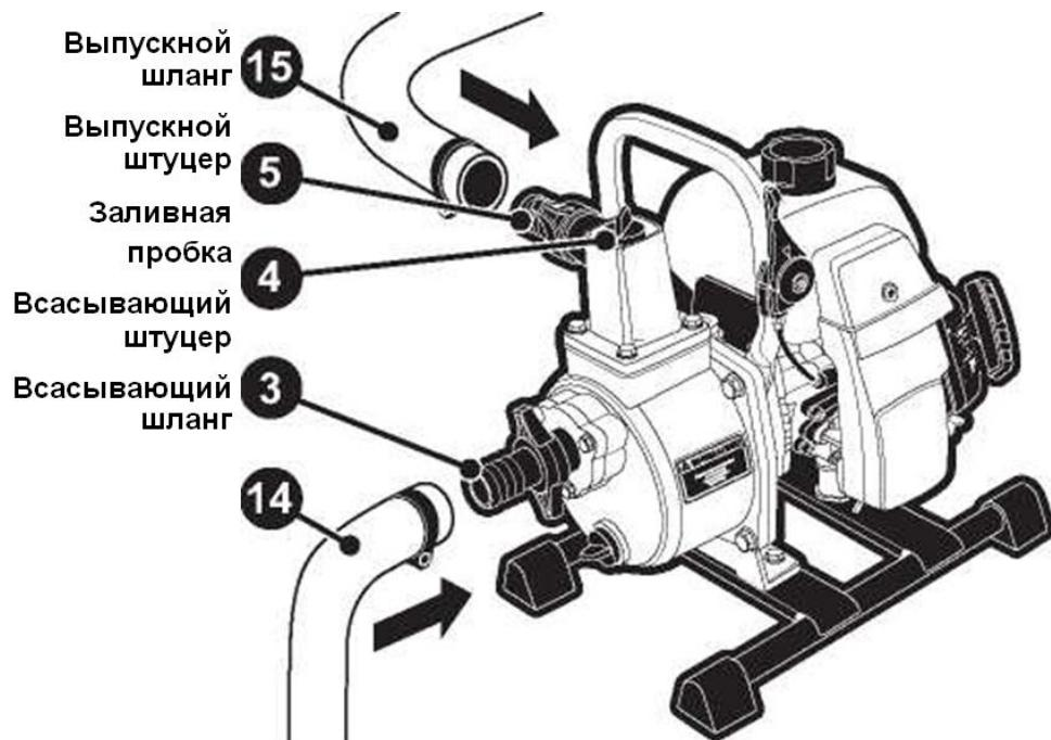
Присоедините всасывающий шланг 14 (не входит в комплект поставки) к всасывающему штуцеру 3 и закрепите шланг хомутом. Рекомендуется установить на нижнем конце всасывающего шланга обратный клапан, для предотвращения слива воды из всасывающей магистрали после отключения мотопомпы.
