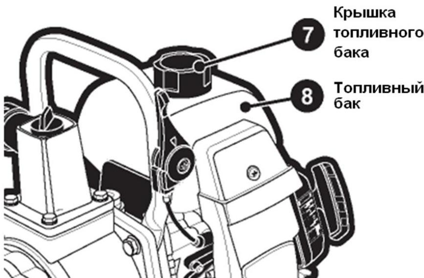
Откройте крышку 7 топливного бака 8 и залейте подготовленное топливо.
