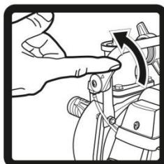
10. Поверните рычаг акселератора в крайнее левое положение.
