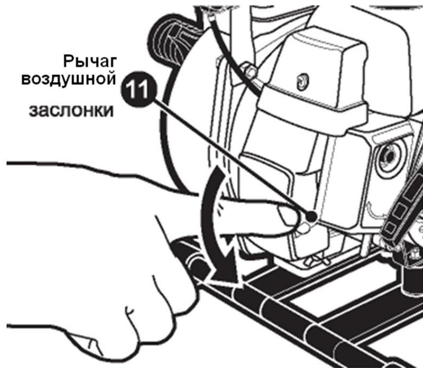
Если двигатель теплый или он запускается при высокой температуре окружающего воздуха - откройте воздушную заслонку наполовину или оставьте ее полностью открытой, установив ее рычаг 11 в положение "Пуск / работа прогретого двигателя" (OPEN).
