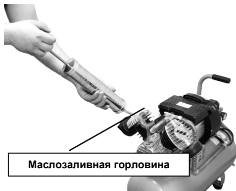
Рисунок 4 - Замена масла в картере компрессорной группы
