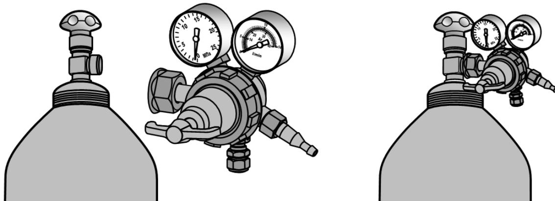
Стальные проволоки свариваются в среде либо чистого углекислого газа CO<sub>2</sub>, либо в смеси углекислого газа с аргоном.
