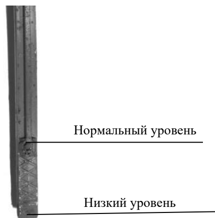
Рисунок 6 – Проверка уровня масла в корпусе редуктора
