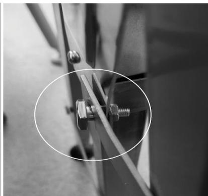
После этого необходимо зафиксировать каркасную стойку (5) и вертикальную перекладину (3). Для этого внутри каркасной стойки есть специальное отверстие. Опускаем внутрь вертикальную перекладину и фиксируем со стойкой при помощи U-образного штифта (21).
