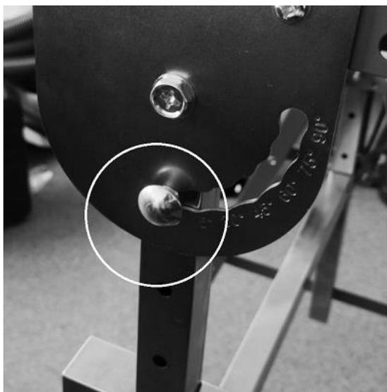
Зажимается болт, опускаются столешницы до необходимого угла, отпускается болт, тем самым он фиксируется (благодаря форме)
