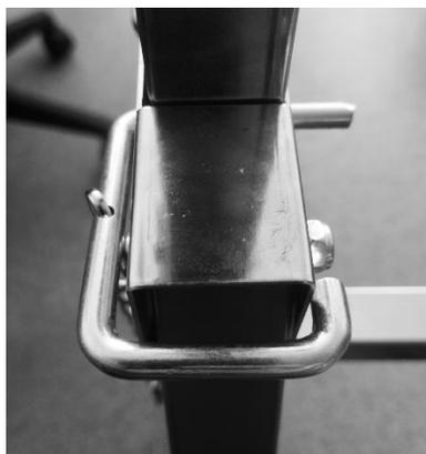
После данного действия проверяем фиксацию вертикальной перекладины. Ввиду транспортировки, она могла ослабиться. Поджимаем
