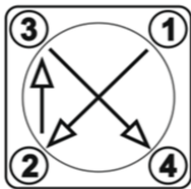
Рисунок 2 - Порядок подтяжки винтов
