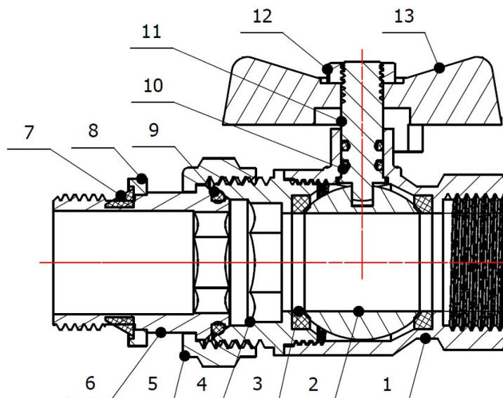
Рис.1. Общий вид шарового крана
