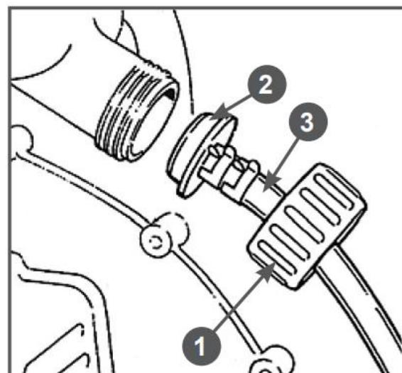
**Шаг 8 –** Установите вместо шланга насоса шланг распылителя 1 (Рис.11), закрепите его гайкой 2 на патрубке бака и хомутом 3 на патрубке напорной трубы.
