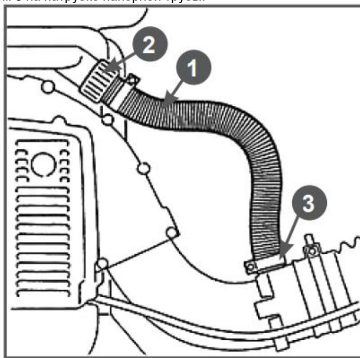
Рисунок 11 - Установка шланга распылителя 1 - Шланг 2 - Гайка соединительная 3 – Хомут
