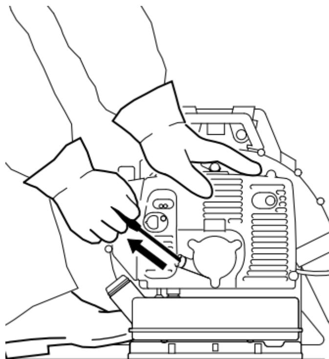
Рисунок 22 – Запуск двигателя
