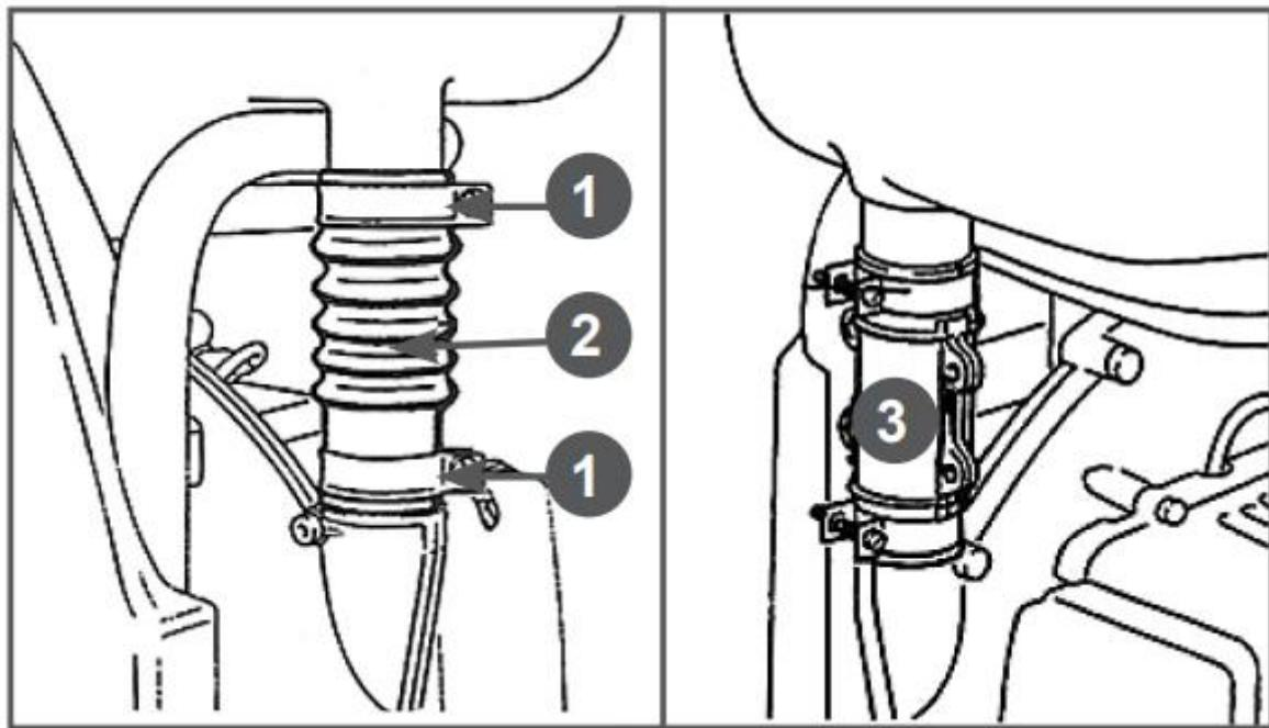
Рисунок 13 - Замена гибкого шланга подачи воздуха на кожух (1 - Хомут 2 - Гибкий шланг 3 – Кожух)
