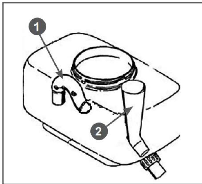
Рисунок 14 - Установка воздушной трубы и воронки в баке 1 - Трубка воздушная 2 - Воронка
