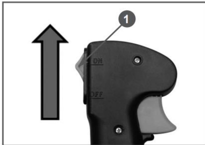
Рисунок 19 - Выключатель зажигания (1 - Выключатель зажигания в положении ON «Вкл»)
