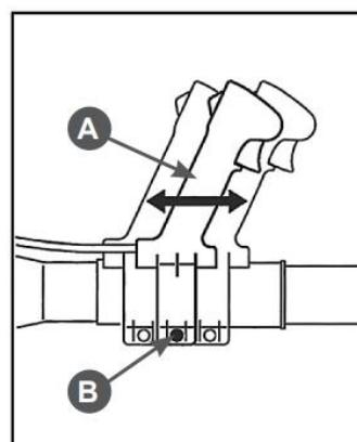
Рисунок 16 - Настройка рукоятки управления (A – Рукоятка; B - Винт хомута крепления рукоятки управления)
