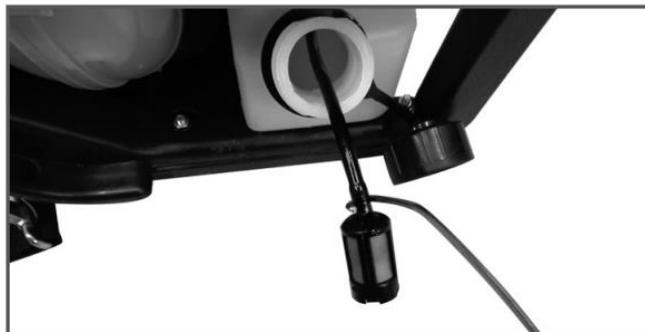
**ПРИМЕЧАНИЕ!** Не вытягивайте топливный шланг полностью из бака. Достаточно вытащить наружу часть шланга с фильтром.
