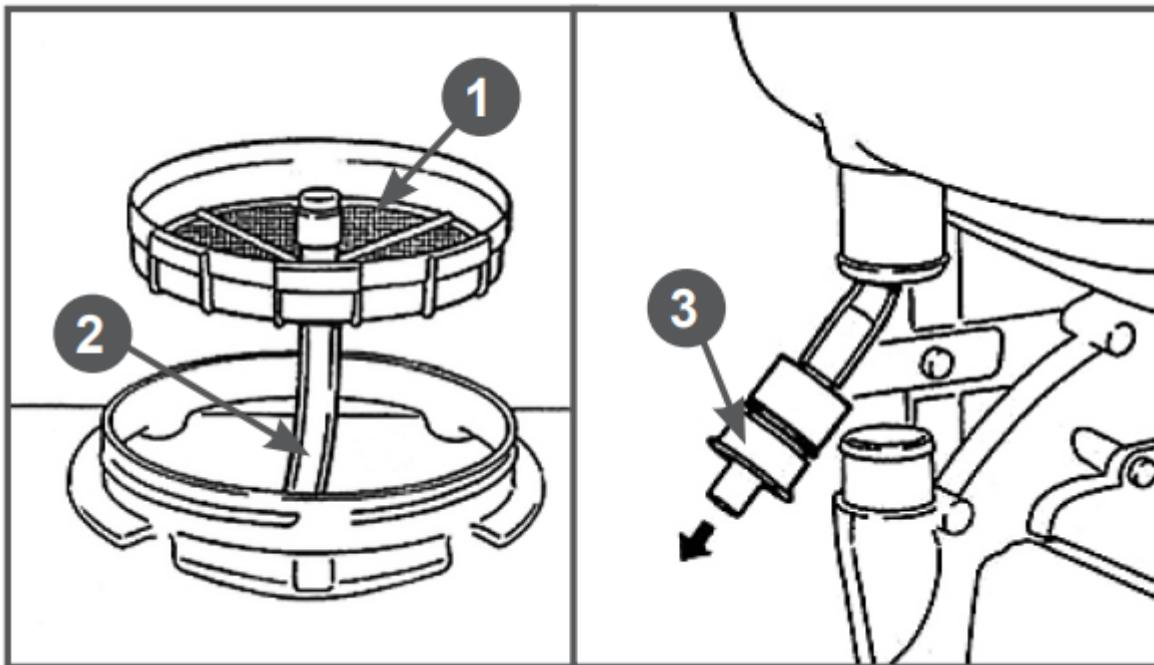
Рисунок 12 - Удаление шланга с редуктором из бака 1 - Фильтр сетчатый 2 - Шланг 3 - Редуктор
