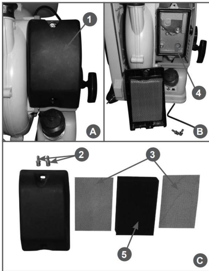
Рисунок 24 - Обслуживание воздушного фильтра (1 - Крышка воздушного фильтра 2 - Винты крепления крышки воздушного фильтра 3 - Сетки металлические 4 - Опора воздушного фильтра 5 - Элемент фильтрующий)
