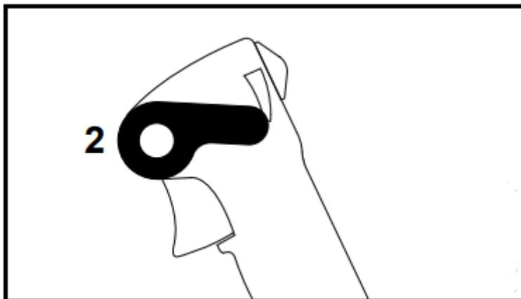
Рисунок 23 – Регулирующий рычаг (нижнее положение – режим «холостого хода»)
